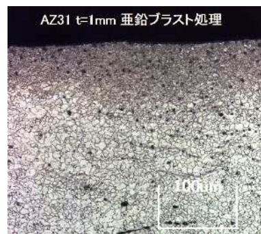
図4 マグネシウム合金（AZ31）の組織観察結果
