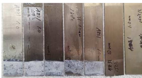
図1 塩水浸せき試験結果 (AZ31)
