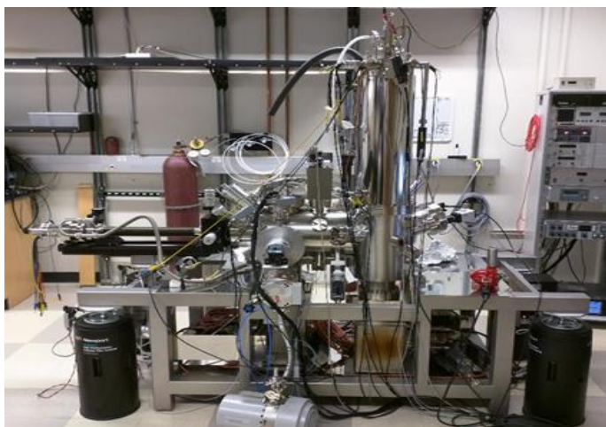
図3.スピン偏極走査型トンネル顕微鏡の一例 (写真は留学先であるオハイオ州立大学 R.Kawakami 研究室の SP-STM)
