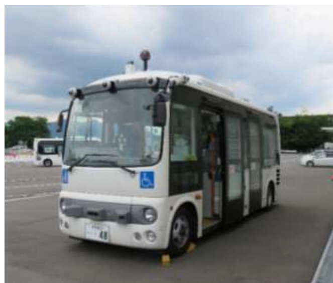
実証で公道走行している車両（日野ポンチョ）。既製の車体にLiDARやカメラ、各種センサー等のシステム一式を取り付けることで、ハンドル・アクセル・ブレーキ操作を自動化した自動運転が可能になる
