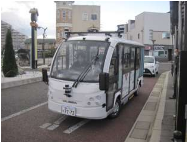
車体にはLiDAR（3Dレーザー）を計8台、カメラを17台装備。車幅は軽自動車ほどで、狭い道でも走行可能
