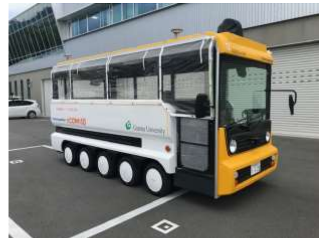
群馬県桐生市の車両製作企業である、(株)シンクトゥギャザー製のグリーンスローモビリティ。最高速度を時速18kmに制限することで、法律面において車体の窓ガラス不要、シートベルト不要、木製ベンチの横向き対面着座が可能等、観光用車両として使いやすくなり、全国の観光地に納入実績あり。同センターによる自動運転への対応も可能
