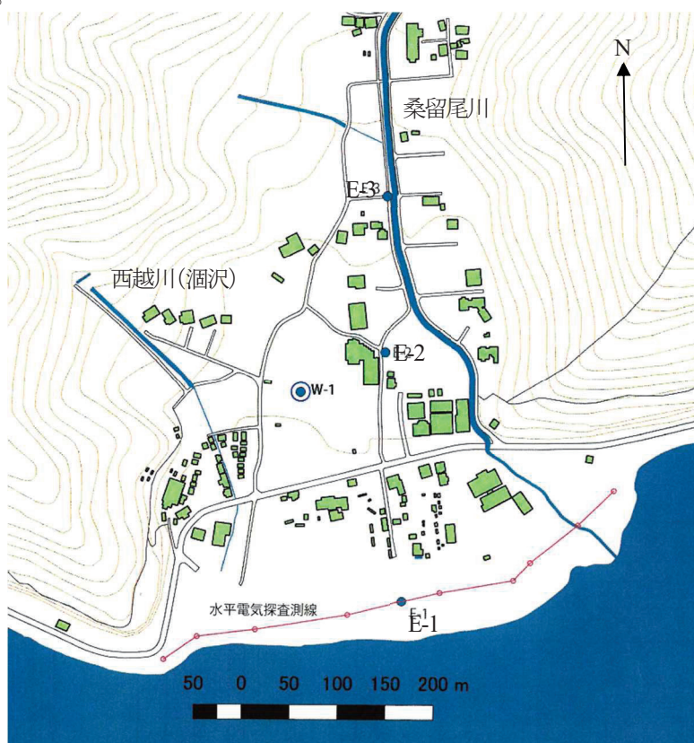
図1 地下電気探査の実施地点(垂直方向; E-1~E-3, 水平方向; E-1を挟む探査測線520m。W-1は既設井)
