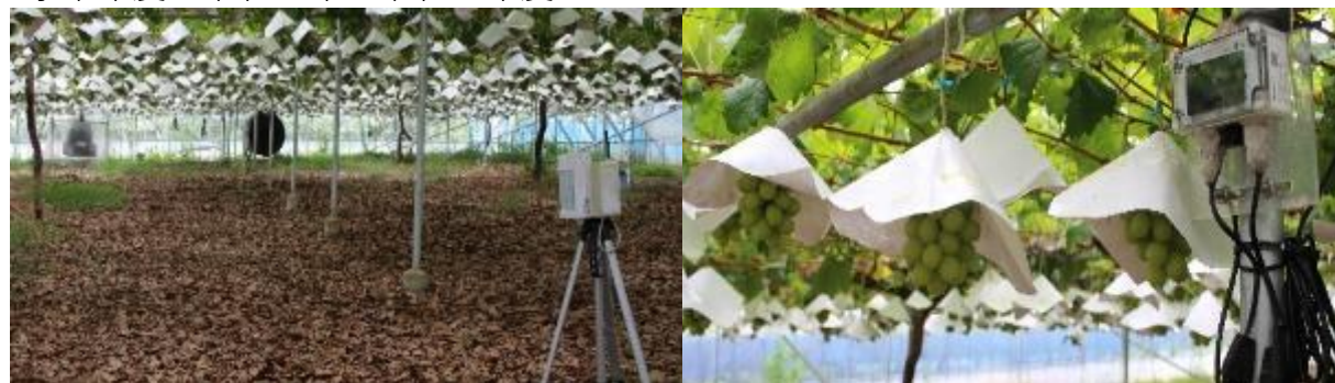
地域版スマートシティの取組：「自営LPWA網」による圃場の環境データセンシング
