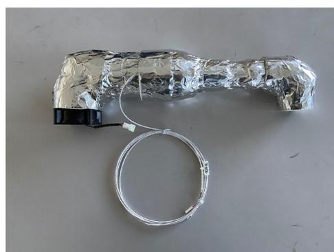
図2 試作した可搬型簡易自作強制通風筒
