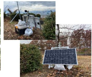
図3 改良したIoTシステム
