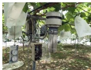
図2 強制通風筒耐久試験
