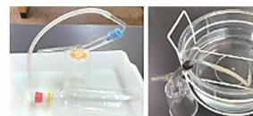
PETボトルで気体を採取 ① 水上置換法 ② 密閉したペットボトル ③ 下方置換法 ④
