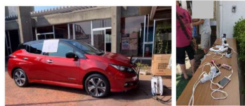
EVからの給電：避難所等で携帯電話充電、扇風機、冷蔵庫等に使用 出典：日産自動車株式会社
