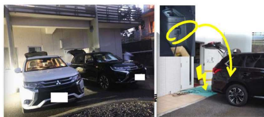
PHVからの給電：老人ホームで洗濯機・洗濯乾燥機に使用 出典：三菱自動車工業株式会社
