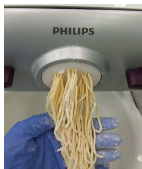
図2 押出式製麺機による製麺の様子
