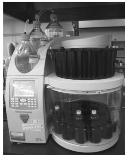
図1 高速溶媒抽出装置
