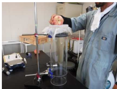
図4 落下試験方法
