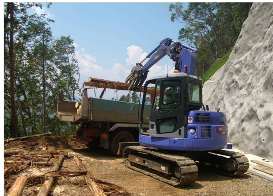
④ 林道沿線における収獲木材の搬出状況
