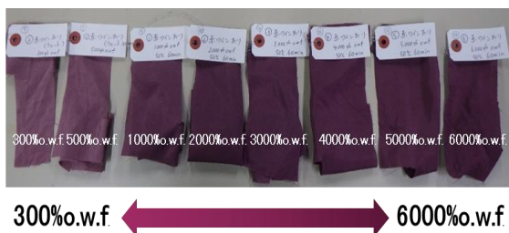
図 6 澱を染材とした染色による濃度変化
