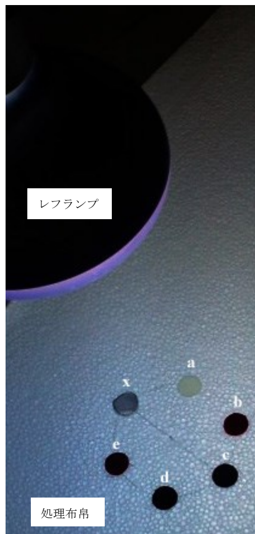
図 1 光吸収発熱保温性試験の様子
