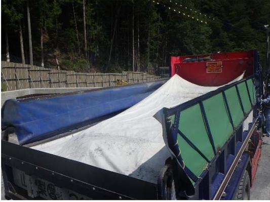
写真 6-4-7 運搬時の浸透防止シート設置状況
