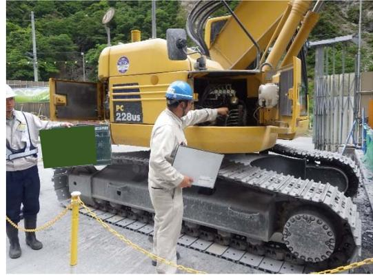
写真 6-2-2 建設機械の点検・整備
