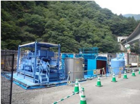
写真 6-1-9 濁水処理設備
