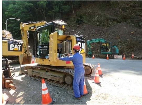
写真 6-1-2 建設機械の点検・整備
