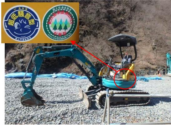
写真 6-1-1 排出ガス対策型・低騒音型
