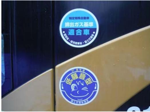
写真 6-4-1 排出ガス対策型、低騒音型
