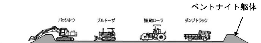
図 2-5 (1) 塩島地区（南）発生土仮置き場における主な施工手順（ベントナイト躯体設置）
