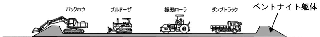
図 2-4 (1) 雨畑地区発生土仮置き場における主な施工手順（ベントナイト躯体設置）
