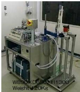
図1 溶射装置
