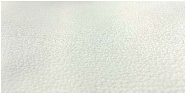
図5 バフ加工を施した銀面
