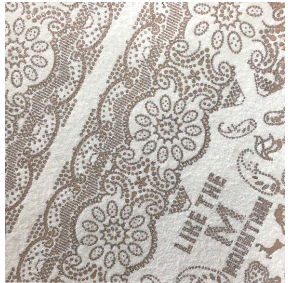
図8 銀面への漆加工の結果（初期）
