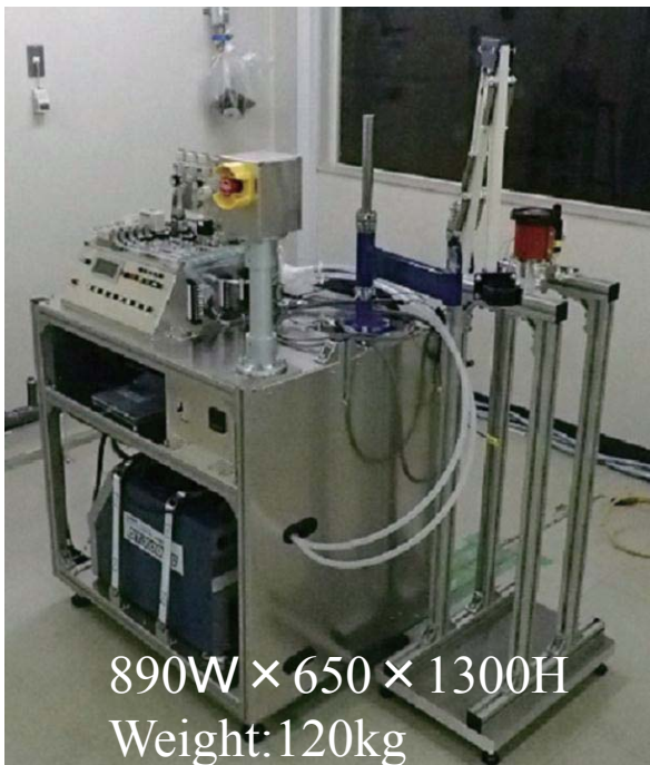
図2 試作開発したマイクロプラズマ溶射装置の外観
