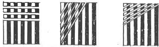
図2 ロウ付けしたものをもう一度シャーリングで角度を決めて切る
