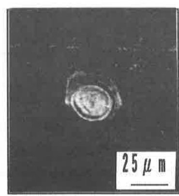
(c) Non Powder I_p; 3.5A, \tau_{on}; 2.0\mu s, \tau_{off}; 4.0\mu s
