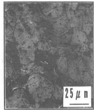
(c) Non Powder I_p; 3.5A, \tau_{on}; 2.0\mu s, \tau_{off}; 4.0\mu s
