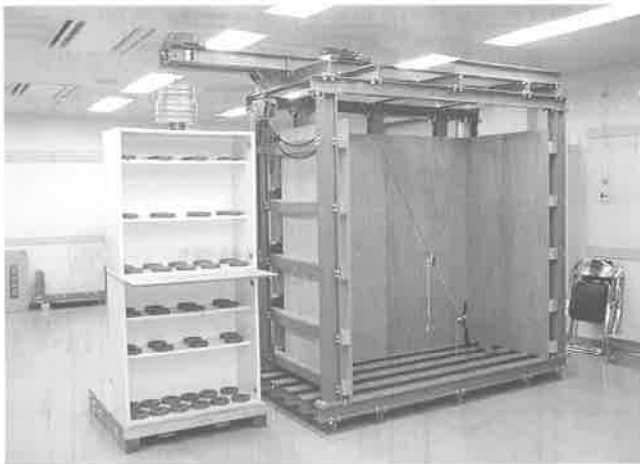
写真1 改良した天板の強度試験装置 (高さ1050mm以上の収納ユニットの場合)
