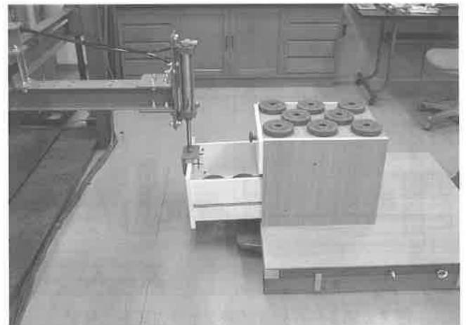
写真4 試作した引出し及びランナーの強度試験装置
