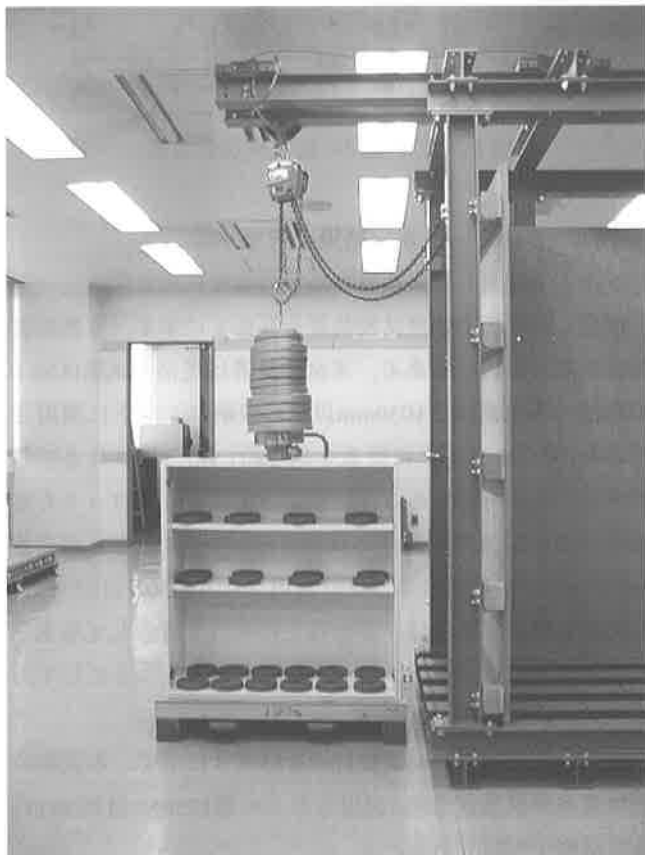
写真2 改良した天板の強度試験装置 (高さ1050mm以下の収納ユニットの場合)
