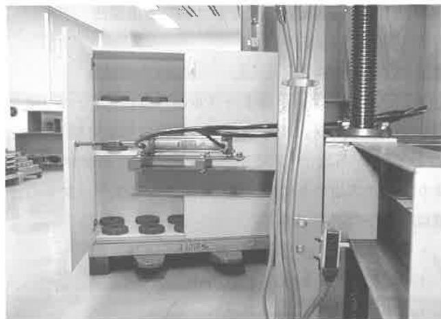
写真6 試作した開き戸の強度試験（水平力試験）装置
