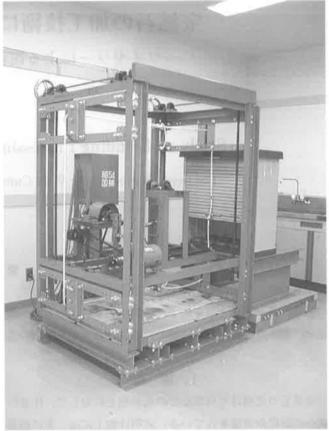
写真7 試作した上下巻戸の耐久性試験装置
