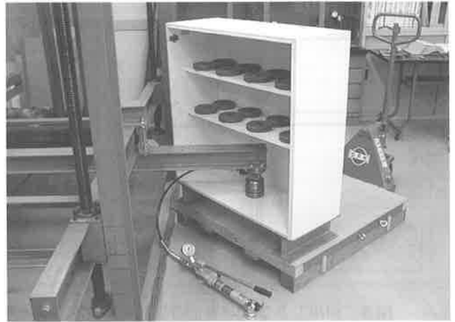
写真3 改良した地板の強度試験装置
