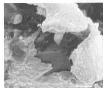
図8 Ti-6Al-4V研削加工後の砥石表面観察結果
