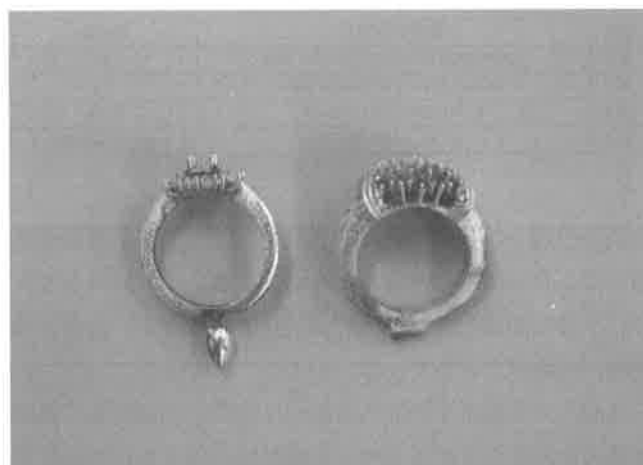
図3 試作液により研磨した鋳造品(指輪)
