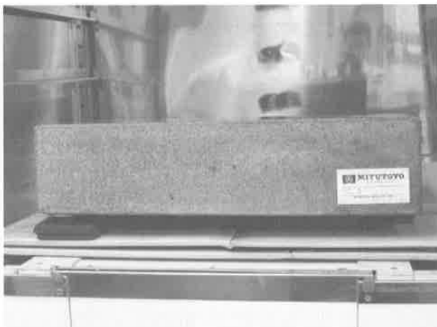
写真1 測定の状況（除振ゴムありの時）
