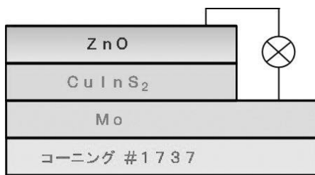
図2 化合物半導体多層太陽電池の構造
