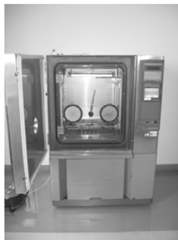
図4 恒温恒湿槽を改造した紫外線照射装置
