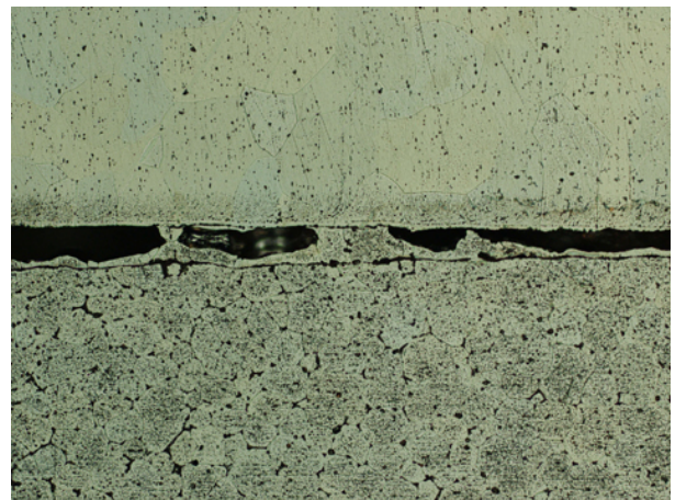
非ジンケート処理 (上) - ジンケート処理試料 (下)
