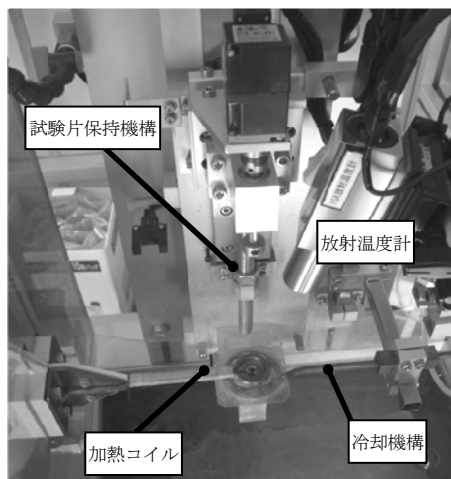
図2 試験片保持/冷却機構部
