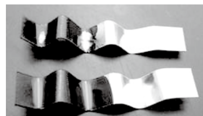
図 4 直流電圧で成膜した試料（上）および交流電圧で成膜した試料（下）
