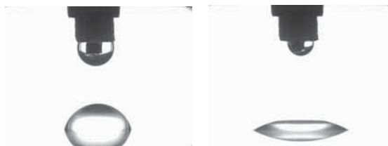
図 3 PET シートの接触角測定時の液滴の様子 （左）未処理 （右）酸素プラズマ 60sec 処理
