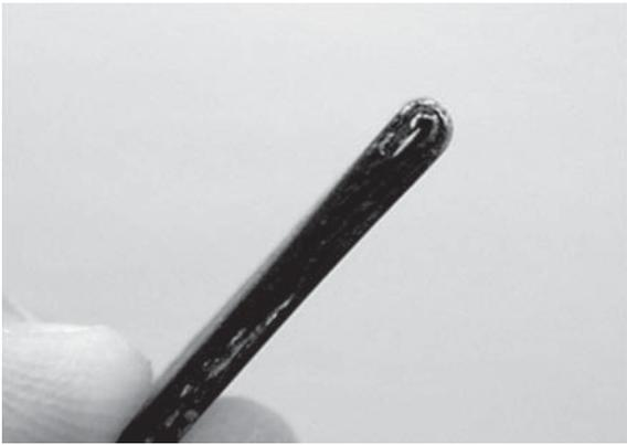
図6 180° 曲げ試験片
