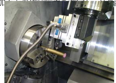
図1 加工機への切削動力計設置状況
