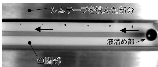
図 12 毛細管現象と空間壁面を利用した送液実験の結果
