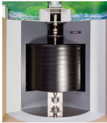
ゆめソーラー館やまなしで展示している次世代フライホイール蓄電システムの模型
