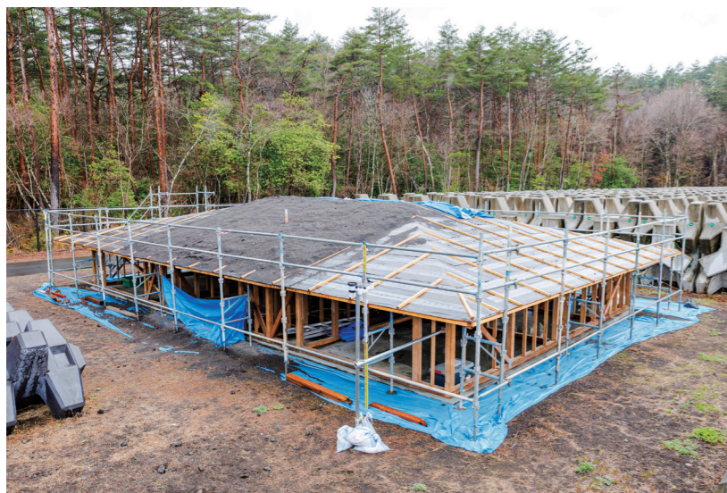
移築された古い建物の屋根に20〜30センチの火山灰を堆積させて安全性を評価する実験を継続中
