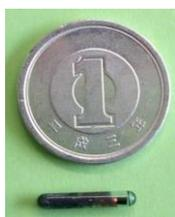
直径 2mm 長さ 8-12mm の電子標識器具で
