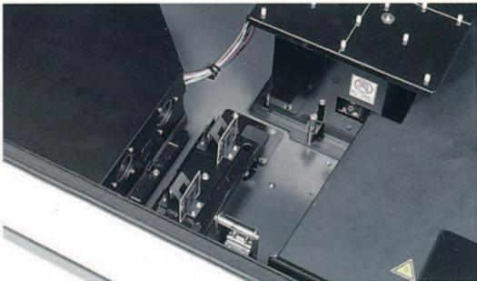
積分球を使用した測定では光の損失が大きいため、感度を重視した測定を行う場合には、直接受光ユニットを使用します。主に液体試料やフィルム試料の測定に用います。
