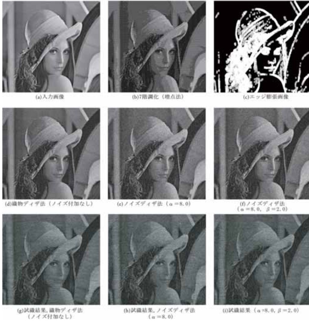
図13 試織結果(織物ディザ法とノイズディザ法)
