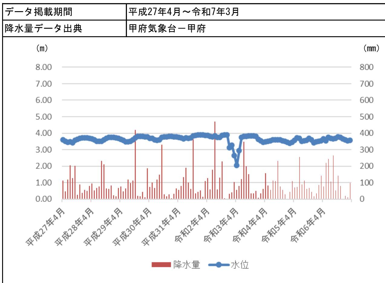
※令和3年1月中旬頃から観測井戸敷地内の別井戸が故障し、地下水が常時漏出していたことにより、一時的に観測井戸の圧力が減少し水位が低下した。
