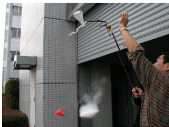
図2. ドライアイス投入装置
