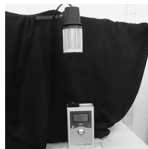
図1 光量子束密度測定の様子
