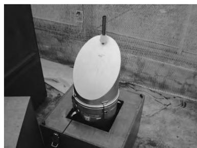
図1 小型堆肥化試験装置
