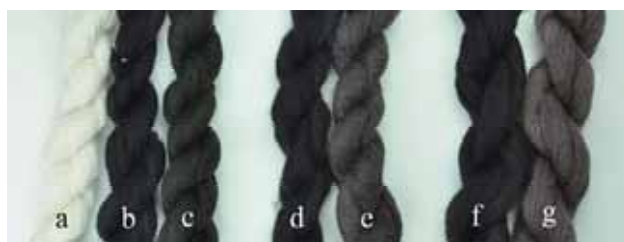
図 1 五倍子染色におけるバナジウム媒染と鉄媒染の比較
