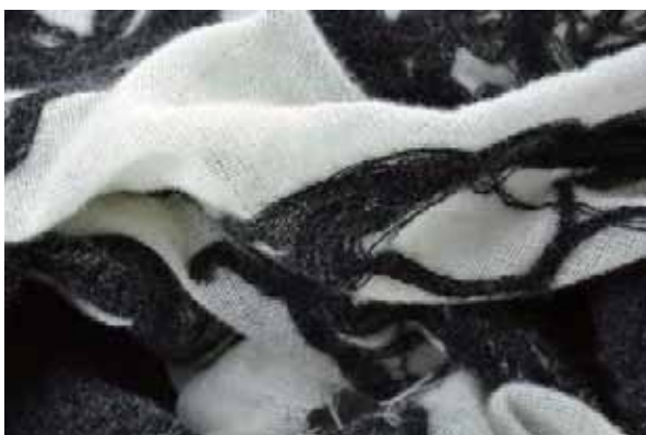
図6 試作品：縮充ウール糸にニードルパンチ加工を実施したテキスタイル
