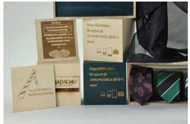
図9 試作品：ネクタイ木箱のレーザ加工
