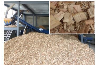
被害木を破碎処理（チップ化）し、幼虫を物理的に殺虫する方法
