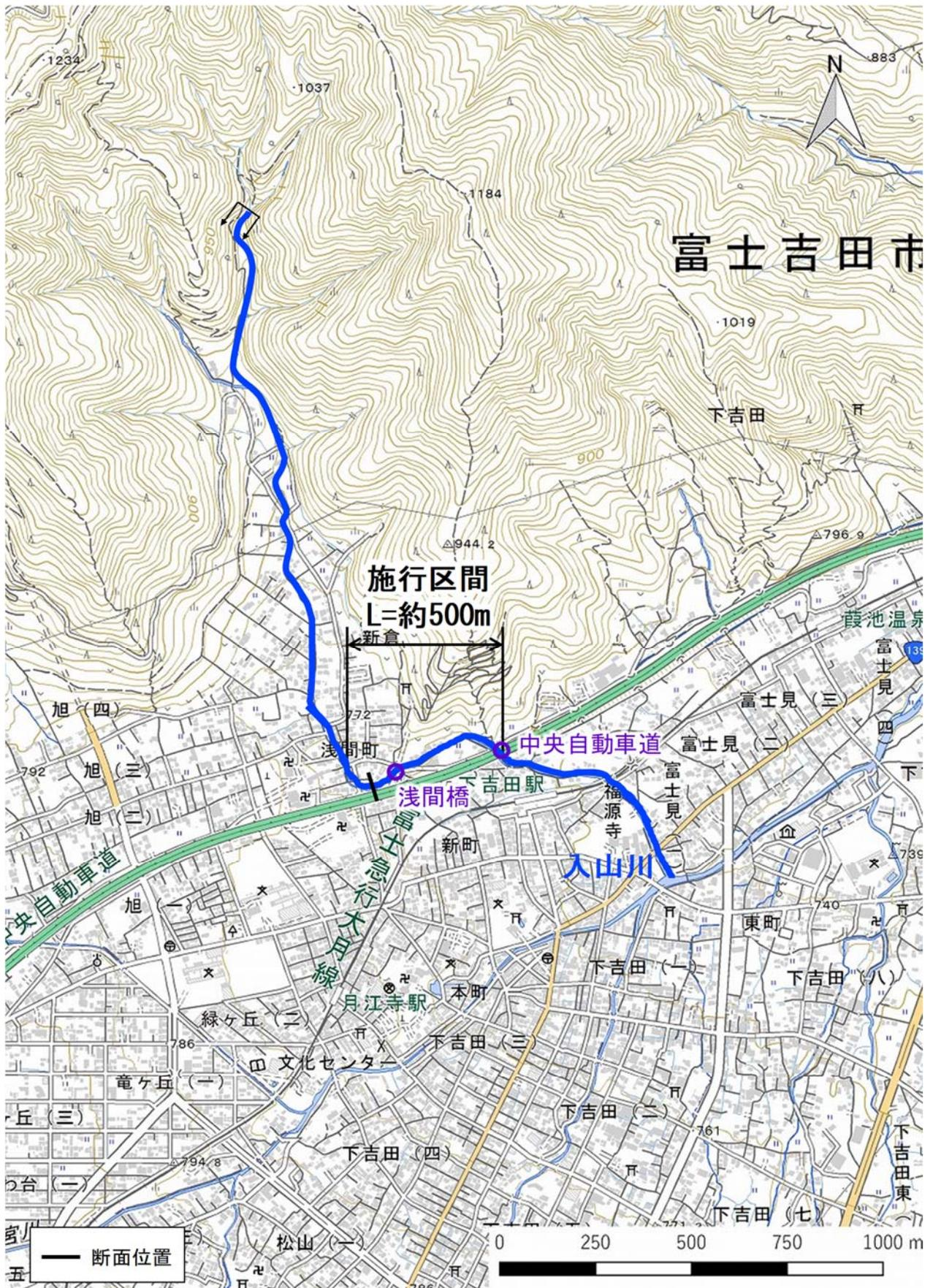
図 3.4 河川工事の施行位置図（入山川）
