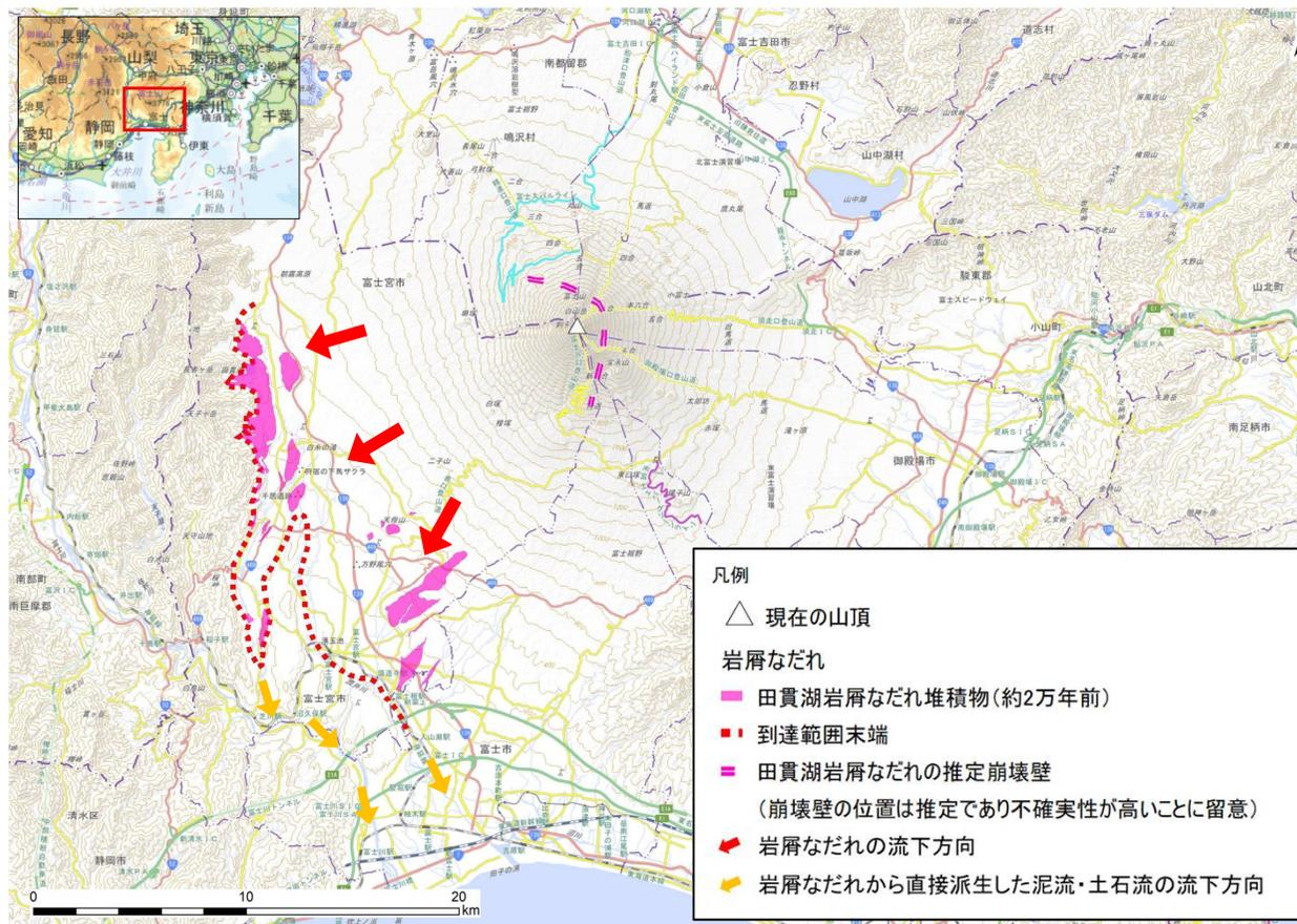
約20,000年前に発生した田貫湖岩屑なだれの実績図
