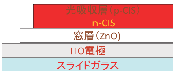
図10 pn 接合 CIS 構造
